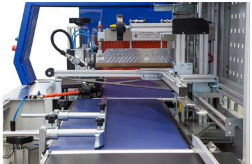
Sistema di saldatura per PE (opzionale)
